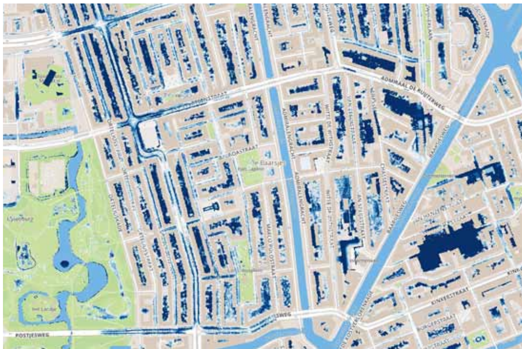
Uitsnede Amsterdam en water op maaiveld bij 60 mm neerslag in één uur De plekken met water op het maaiveld betreffen voornamelijk (lager gelegen) binnentuinen Bron: Amsterdam Rainproof
